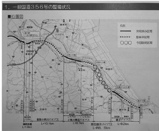
説明会では、銚子土木事務所・鈴木調整課長より「(1)国道356号の整備状況」・「(2)上位計画の位置付け」・「(3)道路計画の検討状況」・「(4)整備効果」・「(5)事業の進め方」の5項目について説明があり、特に「(3)道路計画の検討状況」では、未事業化区間であります逆水門側から桜井町公園付近までの約4.4kmをバイパス区間、それ以東の約4.2kmを現道拡幅区間として計画。道路形状は片側1車線の2車線道路で設計速度は60km/hで計画している旨や「(4)整備効果」では国道356号は大型車混入率が県が管理している道路の
